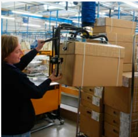
1. Fleksibelt, forlænget håndtag vender "over-the-shoulder" - løft til ergonomisk løft.
