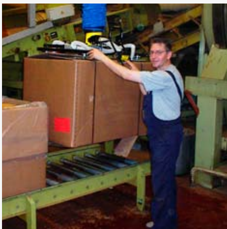
4. Store kasser i den mekaniske industri løftes nemt med VacuMyggen
