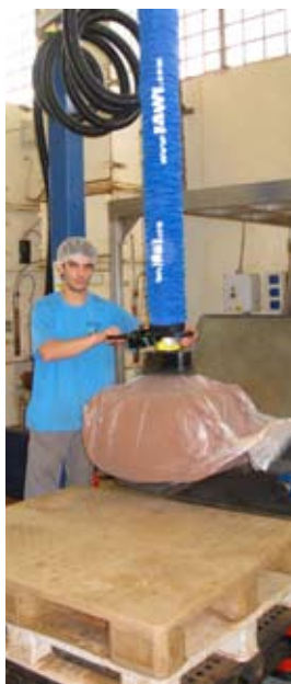
Typisk sækkeløfter - installation.
